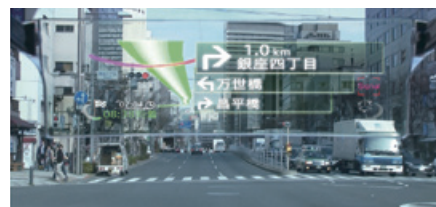
当社が製品化したHUDでは、MEMSミラーを活用したレーザースキャンにより、フロントガラス前方にAR（拡張現実）情報を映し出します。
