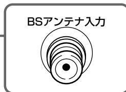
■ BSアンテナからの衛星放送用ケーブル(同軸ケーブル)をつなぎます。この端子は、BSアンテナに取り付けられたBSコンバーターに+15V/+11Vの電源を供給する働きももっています。
