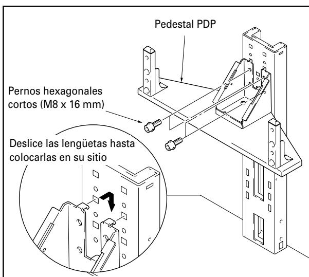
**Ubicación de los agujeros en la columna de soporte central para la fijación del pedestal PDP**
