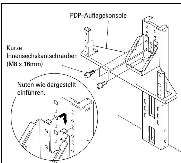
❖ **Positionen der Schraublöcher an der zentralen Stützsäule zur Befestigung der PDP-Auflagekonsole**
