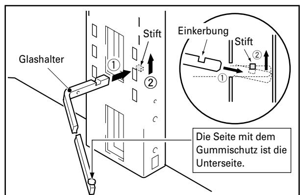
Die Glashalter bzw. Glasstützen können in die oberen, die mittleren oder die unteren Öffnungen eingeführt werden und können so die Höhe der Glasplatte festlegen (Die mittleren Öffnungen sind für den Gebrauch bei der Standard-Installation vorgesehen).
