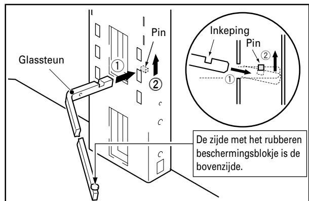
De glassteunen kunnen in de bovenste, middelste of onderste openingen worden ingebracht om de hoogte van het glaspaneel in te stellen (De middelste openingen zijn bestemd voor standaardbevestiging).
