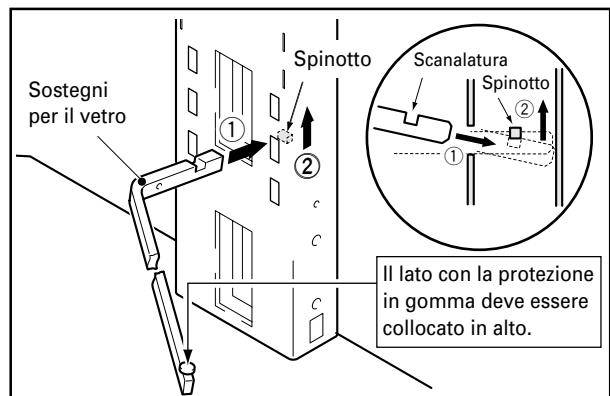
I perni per il vetro possono essere inseriti nei fori superiori, centrali o inferiori per regolare l'altezza del pannello di vetro (I fori centrali sono progettati per essere usati nell'installazione standard).
