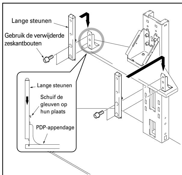
**Afhankelijk van de lengte van de steunen die aan de PDP-appendage zijn bevestigd, zijn er verschillende soorten plasma-displays die kunnen worden gebruikt, en daarom dient u vóór montage na te gaan of de display die gemonteerd wordt geschikt is.**
