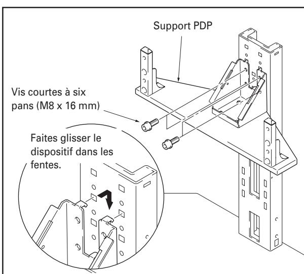
**❖ Emplacement des orifices sur la colonne de support centrale pour fixer le support PDP**
