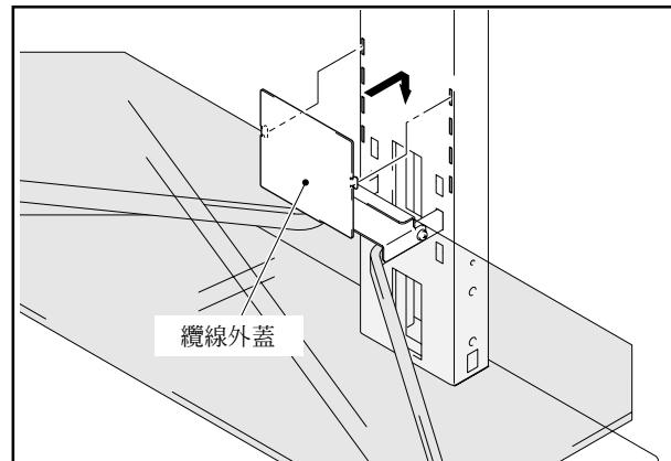
**11** 將一個支柱外蓋安裝到中央支柱以覆蓋住纜線，並將其以螺絲固定（M4×10公釐：銀色）（兩顆螺絲，在頂部和底部）。
