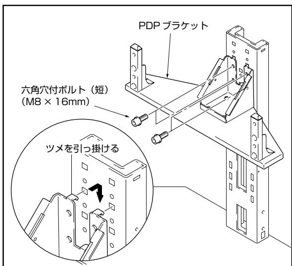
❖ センター支柱のPDP ブラケット取り付け穴位置
