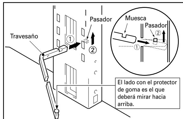
Los travesaños pueden instalarse en los agujeros superiores, medios o inferiores para ajustar la altura del panel de vidrio (Los agujeros medios se han diseñado para su uso en la instalación estándar).
