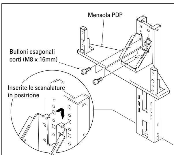
**Posizioni dei fori sulla colonna di sostegno centrale per il montaggio della mensola PDP**
