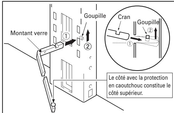
Les montants de verre peuvent être insérés dans les orifices supérieurs, centraux ou inférieurs pour régler la hauteur du panneau en verre (Les orifices centraux sont conçus pour une installation standard).
