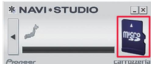
▲ボタンをクリックし、「SD カードの取外しが可能な状態になりました。」の確認画面が表示されましたら、「OK」をクリックして microSD メモリーカードを取り外してください。
