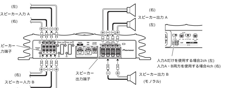
スピーカー入力端子を使用しているとき、ゲインコントロールは左側に回し切った位置が目安となります。ただし音量が不足していると感じたときは、ゲインコントロールを右側に回しますが、右側に回しすぎるとノイズが目立つ場合があるので好みにあった入力レベルに調節してください。RCA入力時は、スピーカー入力端子に何も接続しないでください。
