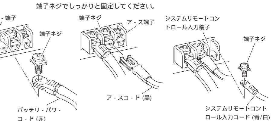
バッテリーなどの配置によりバッテリーパワーコードを高温となる場所に配置する場合は、RD-224 (別売) に付属のコルゲートチューブでバッテリーパワーコードを保護し配置してください。
