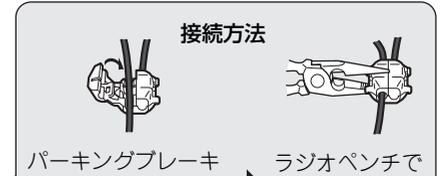
バックランプのリード線はさみ込む。 → ラジオベンチで強くはさむ。
