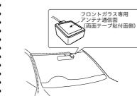
[フロントガラス専用アンテナを取付ける場合]
