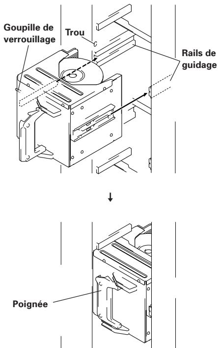
La figure ci-dessus montre l'introduction d'un magasin dans une baie avant. L'introduction d'un magasin dans une baie arrière y ressemble beaucoup mais notez que le meilleur endroit d'installation est celui qui se trouve le plus en retrait.
