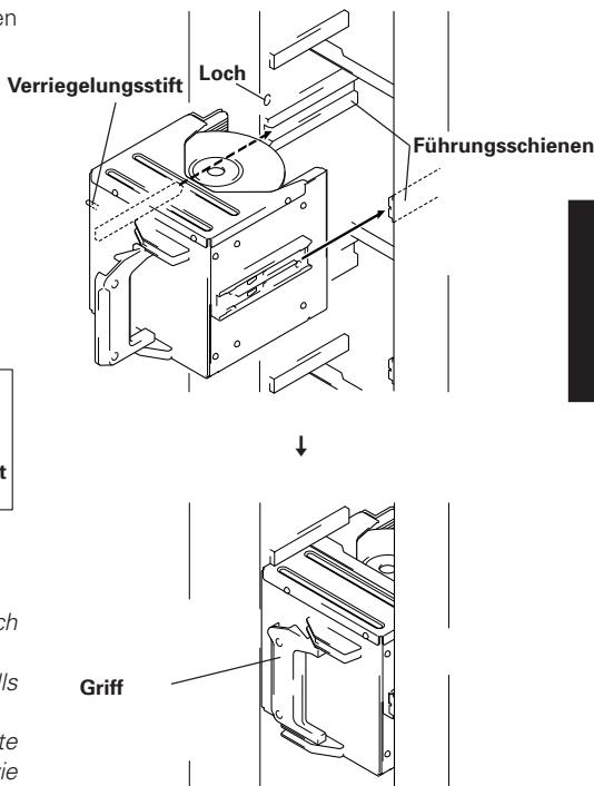
Oben ist das Einsetzen in ein Magazinfach auf der Vorderseite dargestellt. Das Einsetzen in die rückseitigen Magazinfächer erfolgt ähnlich. Um ein Disc-Magazin aus dem Wechsler zu nehmen, klappen Sie den Griff aus, und ziehen Sie das Magazin aus dem Wechsler.
