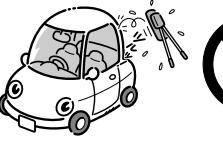
アンテナは不安定な場所には取り付けないでください。ガラス曲面がきつく取付金具がガラス面に合わないなど不安定な場所に取り付けると、走行中に落下し事故などの原因となることがあります。
