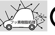
アンテナをフッ素樹脂処理されたボディやガラス、及び再塗装されたボディに、両面テープで貼り付けてください。走行中にアンテナがはがれて落下し、ボディに傷をつけたり、事故の原因となることがあります。
