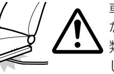
車体やネジ部分、シートレールなど、車両の動く部分にコード類をはさみ込まないように配線してください。断線やショートにより、事故・感電・火災の原因となることがあります。
