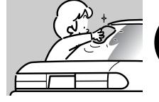
アンテナを両面テープで貼り付ける場合は、貼り付け場所をきれいに拭き、確実に固定してください。貼り付け場所をきれいにしないと、走行時の振動等でアンテナがはがれて落下し、ボディに傷をつけたり、歩行者に接触したりして事故の原因となることがあります。
