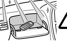
リモコンは直射日光の当たる場所や高温、高湿の場所を避けて保管してください。ケースの変形、内部電池の破裂、液もれの原因となることがあります。
