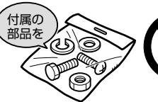
必ず本機および取付キットに付属の部品を指定どおりに使用してください。指定以外の部品を使用すると、機器内部の部品を損傷したり、しっかりと固定できずに外れることがあります。
