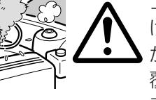
コード類の配線は、高温部を避けて行ってください。コード類が車体の高温部に接触すると被覆が溶けてショートし火災や感電の原因となることがあります。
