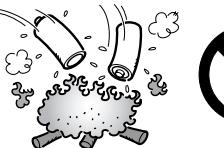
電池をショートさせたり、分解したり、加熱したりしないでください。また、火や水の中に入れないでください。電池の破裂、液もれにより、火災やケガの原因となることがあります。
