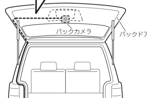
●車種によってバックカメラのコードを下側から車内へ引き込めない場合、図のように防水パッドの手前でコードを U 字に曲げ、雨水などがコードを伝わって車内に入らないようにしてください。
