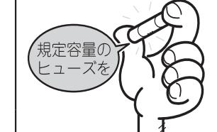
ヒューズを交換するときは、必ず表示された規定容量のヒューズをご使用ください。規定容量以上のヒューズを使用すると、火災の原因となります。
