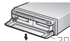
※強く押すと、フロントドアの取り付け部が破損しますのでご注意ください。
