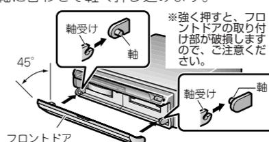
※強く押すと、フロントドアの取り付け部が破損しますので、ご注意ください。
