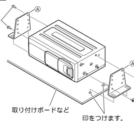
縦置きで取り付ける場合は、“ドリルで穴を開けない取り付けかた”的1を参照してAを取り付けてください。
