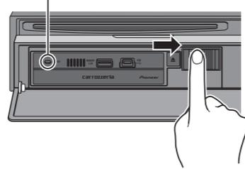
エンジンスイッチがON (本機の電源がON) の状態でブレイユニットロックレバーをスライドすると、ブレイユニット前面のブレイユニットPOWERランプが点滅を始めます。点滅が終了し、ランプが消灯したらブレイユニットを取り出すことができます。
