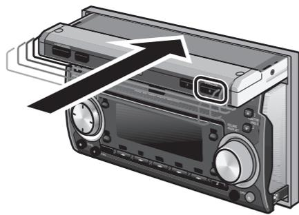
ブレインユニットはモニターが閉じている状態で挿入や取り出しをしてください。挿入の際、立ち上がっているモニターの底面にブレインユニットが接触し落とすと、パネルやブレインユニットが破損する恐れがあります。
