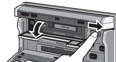
エンジンスイッチがON (HDDナビゲーションサーバーの電源がON) の状態でブレインユニットカバーを開けると、ブレインユニット前面のブレインユニットPOWERランプが点滅を始めます。点滅が終了し、ランプが消灯したらブレインユニットを取り出すことができます。
