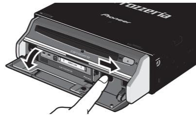
エンジンスイッチがON (HDDナビゲーションサーバーの電源がON) の状態でブレインユニットカバーを開けると、ブレインユニット前面のブレインユニットPOWERランプが点滅を始めます。点滅が終了し、ランプが消灯したらブレインユニットを取り出すことができます。
