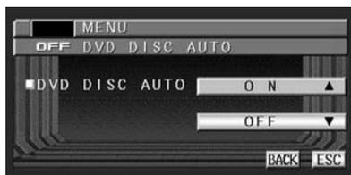
本機にディスクが挿入されたとき、自動再生するように設定されます。
