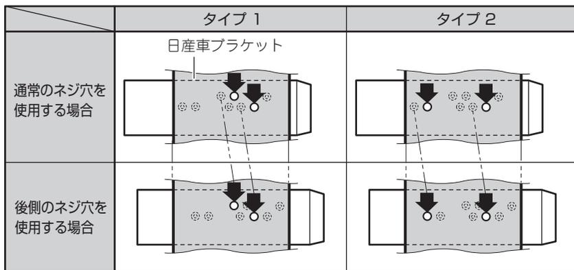
取り付けスペースの奥行きが少ないなどの理由で「後側のネジ穴を使用する場合」には、加工するなどして、必ず片側2カ所ずつネジ止めしてください。片側1カ所止めの場合、音飛びや現在地を正しく表示できなくなるなどの原因となります。また、車種によっては窓パネルの加工なども必要となりますので、商品の取り付けにあたっては、お買い上げの販売店にご相談ください。
