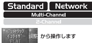
本機は、3バンドパラメトリックイコライザーを搭載しています。この機能を使うと、スピーカーごとにバンド／中心周波数／レベル／帯域幅（Q）を細かく調整できます。
