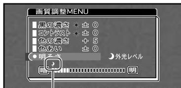
TVモニター前面の外光センサーが、周囲の明るさを感知して、現在の周囲の明るさ(外光レベル)をマークの色、形、および位置で表示します。
