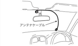
3 Aピラーカバーを外して、アンテナケーブルを通します。
