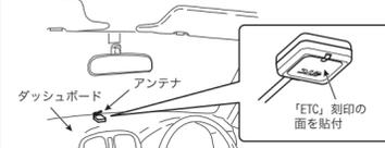
2 アンテナケーブルをフロントガラスとダッシュボードの内張りの隙間に押し込みます。
