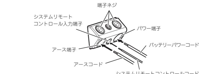
● バッテリーなどの位置によって、高温となる場所にバッテリーパワーコードを配置しなくてはならない場合は、RD-228（別売）に付属のコルゲートチューブでバッテリーパワーコードを保護してください。
