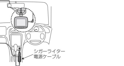
**!** シガーライター使用直後は電源端子が高温になっています。そのままシガーライター電源ケーブルを挿入すると先端が溶断・ショートする可能性があります。しばらく時間をおいて熱が冷めてからシガーライター電源ケーブルを挿入してください。
