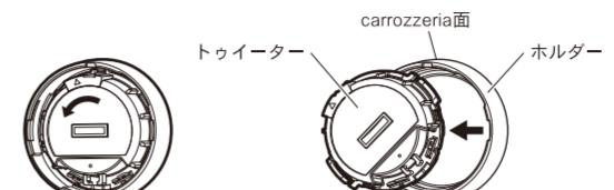
※再度トゥイーターをホルダーに取付ける場合は、取外しと逆の手順でホルダーにトゥイーターをはめ込み、右方向に回転させて固定します。
