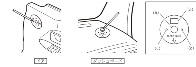
2. 四角穴(a)と丸(b)の2箇所にマーキングの通り穴を開けます。また、丸(c)の選択した側にネジ⑮用の下穴を開けます。
