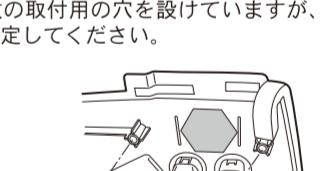
※プラケットには複数の取付用の穴を設けていますが、車両側の樹脂カバーに合わせて使用する穴を選定してください。
