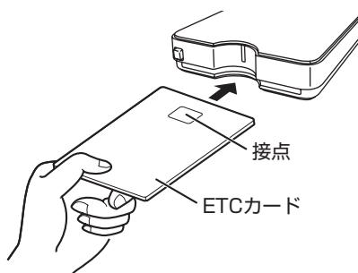
本機からブザー音が「ピー」と鳴り、「ETC カードを認証しました。」の音声案内が流れ、本機の本体 LED ランプが青に点灯し、外部アンテナの LED ランプが青に点灯します。
