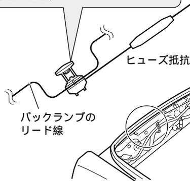
バックランプ(シフトレバーがリバース[R]のときに点灯するランプ)の位置を確認し、トランク内から、バックランプのリード線を取り出します。
