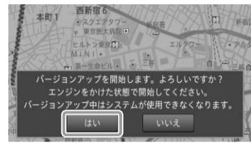
ナビゲーション本体が再起動し、バージョンアップが開始されます。(進捗率はあくまで進捗の目安で、進む時間が遅くてもバージョンアップを行っています。)
