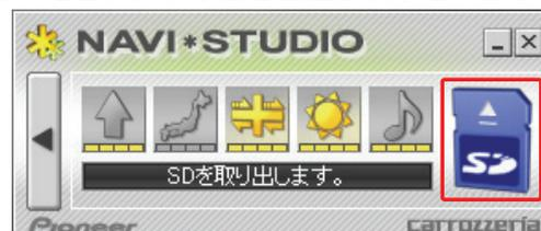
▲ ボタンをクリックし、「SDカードの取外しが可能な状態になりました。」の確認画面が表示されましたら、「OK」をクリックしてSDメモリーカードを取り外してください。
