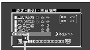
モニター前面の外光センサーが、周囲の明るさを感知して、現在の周囲の明るさ(外光レベル)をマークの色、形、および位置で表します。
