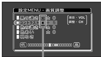
TVモニター前面の外光センサーが、周囲の明るさを感じ、現在の明るさを示すマークが画面に表示されます。
