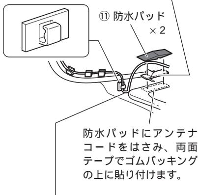
雨水がコードを伝わって車内へ入らないように、コードをゴムパッキングの外側でU字形に曲げます。
