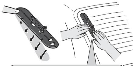
リアーガラスに密着するように、指で強く押しつけてください。(貼り付けた後、空気が入っていないか車内から確認し、空気が入っていたらさらに強く押しつけてください。)
