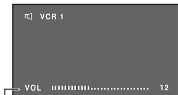
内蔵スピーカーの音量は、0～30の範囲で調整できます。(約4秒間、音量が表示されます。)
