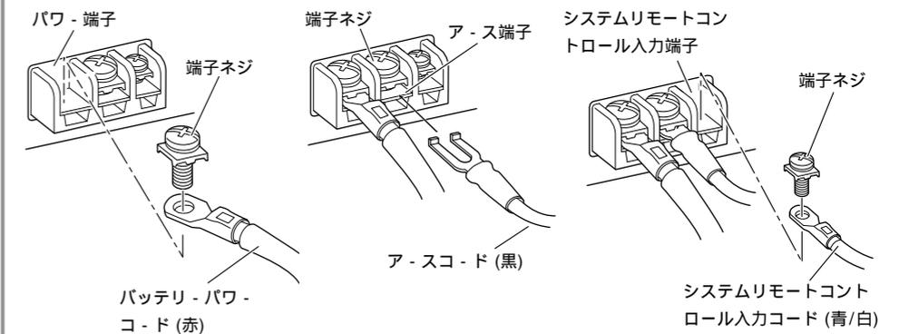
バッテリーなどの位置によって、高温となる場所にバッテリーパワーコードを配置しなくてはならない場合は、RD-226 (別売) に付属のコルゲートチューブでバッテリーパワーコードを保護してください。
