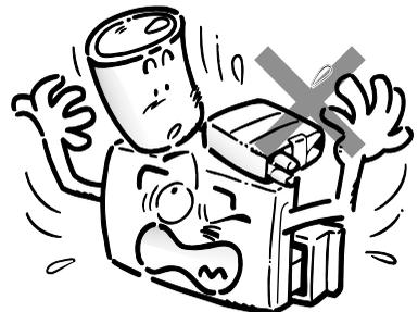
TVモニターを立ち上げたときに、TVモニターがエアコンの吹き出し口の近くにくる場合は、エアコンの風がTVモニターに当たらないようにしてください。ヒーターの熱で液晶が壊れたり、クーラーの冷気でTVモニター内部に水滴がついて故障する恐れがあります。
