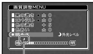
TVモニター上部の外光センサーで、周囲の明るさを感知して、現在の周囲の明るさ（外光レベル）をマークの色、形、および位置で表示します。
