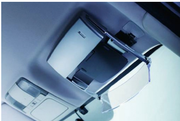
図20 HUDユニット取付け
