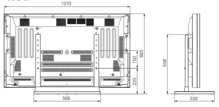
※床に固定する際のねじは、M6、長さ20mm以上のものを使用してください。
