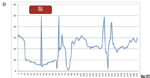
図6 輪郭の法線方向に存在する領域の画素数を輪郭方向に並べたグラフ。グラフ左方の指領域ではDが小さい。
