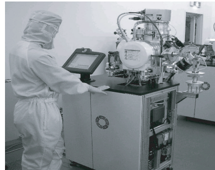
図9 スパッタ装置(ユナクシス社製CubeStar)の写真
