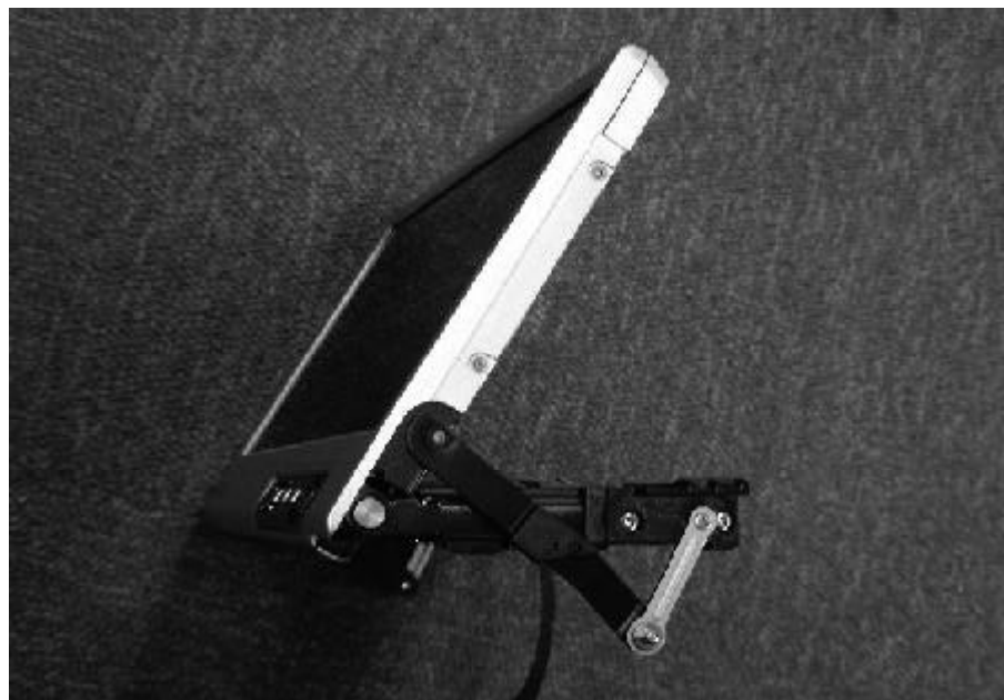
図14 側面からみた駆動メカユニット(立ち上がり状態)
