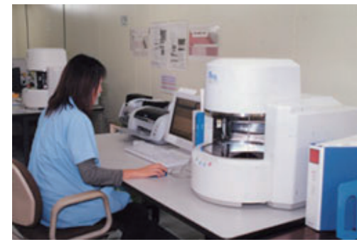
蛍光X線分析装置により有害物質を厳密にチェック
