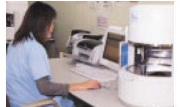
蛍光X線分析装置により有害物質を厳密にチェック
