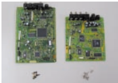
鉛、六価クロムをフリー化したメイン基板ユニットとビス類（右）と従来品（左）
