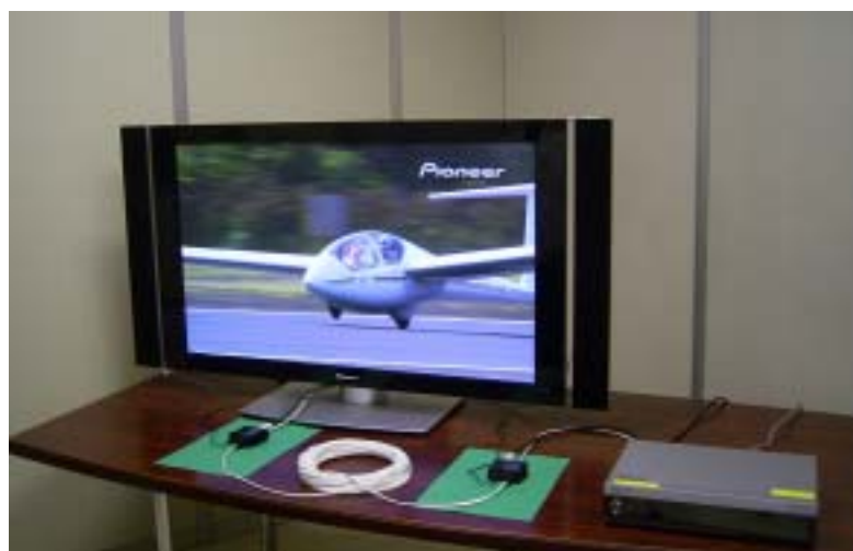
図 1 MR, PDP と DVI 光シリアルリンク
