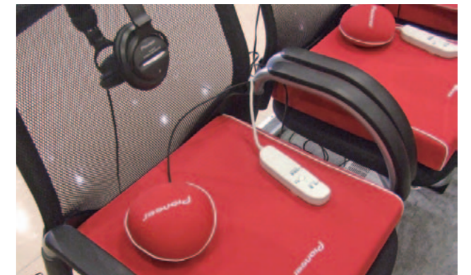
体感音響システムは、振動ユニットを内蔵したクッションと小型スピーチにより、臨場感あふれる振動を直接身体に伝えます
