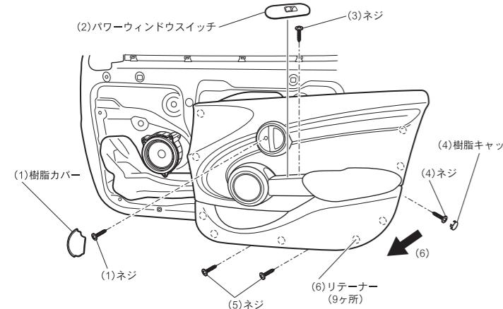
■吸音・制振マルチファンクションマット/制振シート/遮音パッキン貼付け位置
