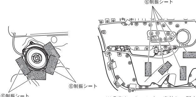
※吸音クッションを一度外し、所定の位置に制振シートを貼付け、その後元に戻してください。
